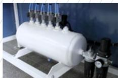
Sistema de distribuição de pressão inteligente, faz com que todos os cabeçotes recebam a pressão de ar uniforme para a prensagem.
