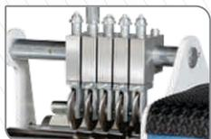
Sistema de corte com 5 facas independentes, com sistema simples de regulagem das facas.
