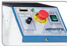
Painel controlador de velocidade (potenciômetro).
