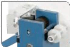
Sistema de tração com motor de passo, maior precisão para puxar o material, melhor desempenho da máquina.
