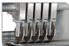
Sistema de corte com 5 facas independentes, fácil regulagem das facas.
