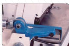
A tesoura pneumática Metalnorte pode ser fixada direto em máquinas de costura para automatizar o processo de corte, ou sob uma mesa/bancada para corte manual de aviamentos em geral.
