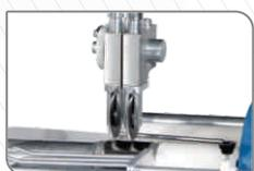
Sistema de corte com 2 facas independentes, com sistema simples de regulagem das facas.
