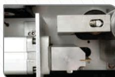
Motor de passo com velocidade ajustável e faca térmica para o corte e selagem do aviamento.
