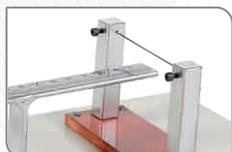
Área de corte de 60mm com régua para auxiliar na medição do material a ser cortado.
