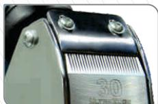
Regulagem de abertura entre lâmina para melhor ajuste do arremate dos fios.
