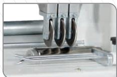
Sistema de corte com 3 facas independentes, simples regulagem das facas.
