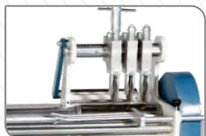
Sistema de corte com 3 facas independentes, com sistema simples de regulagem das facas.
