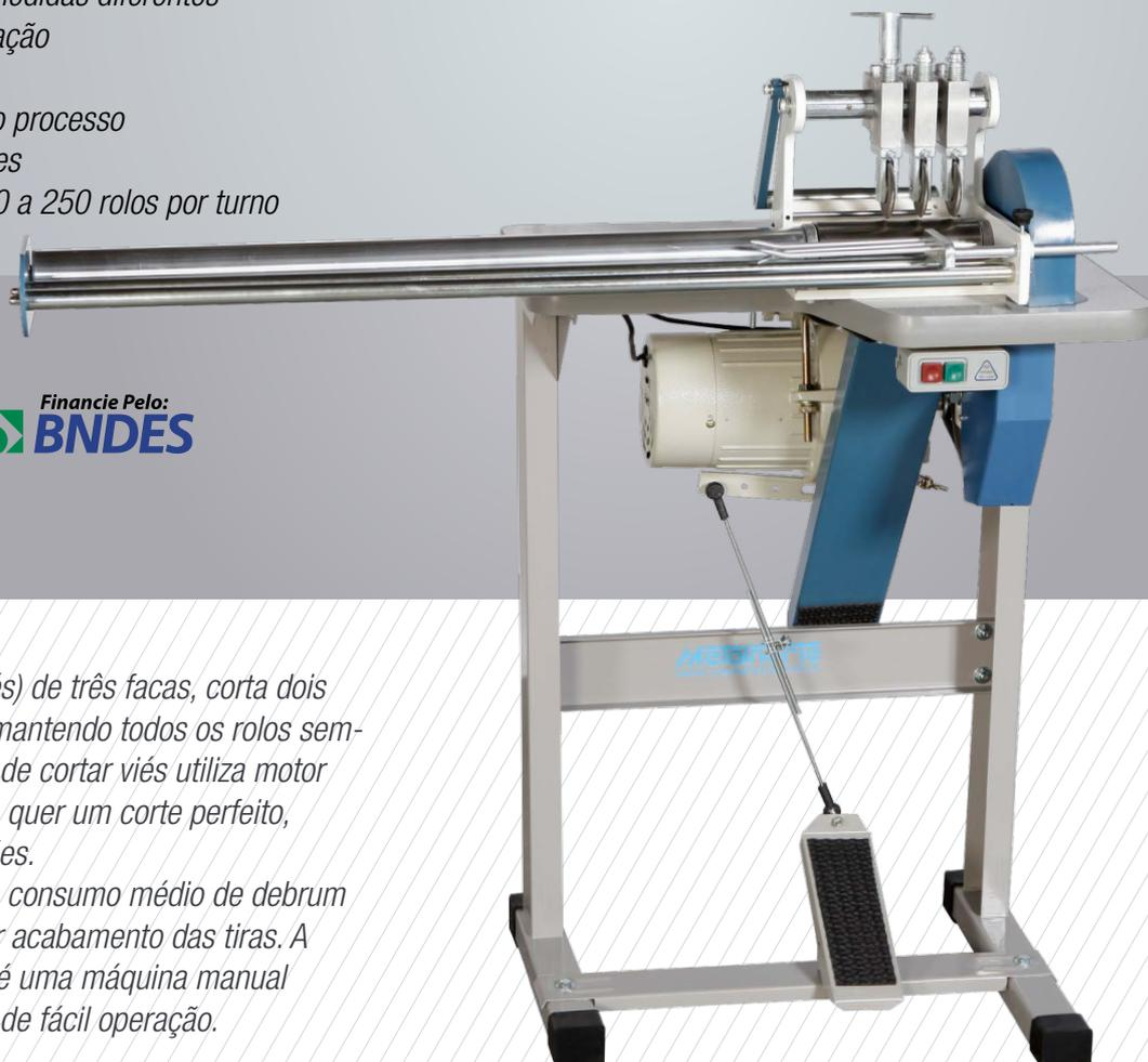
Máquina para cortar debrum (viés) de três facas, corta dois rolos e ao mesmo tempo refila, mantendo todos os rolos sempre padronizados. Esta máquina de cortar viés utiliza motor industrial, e é própria para quem quer um corte perfeito, adequado para médias confecções.
