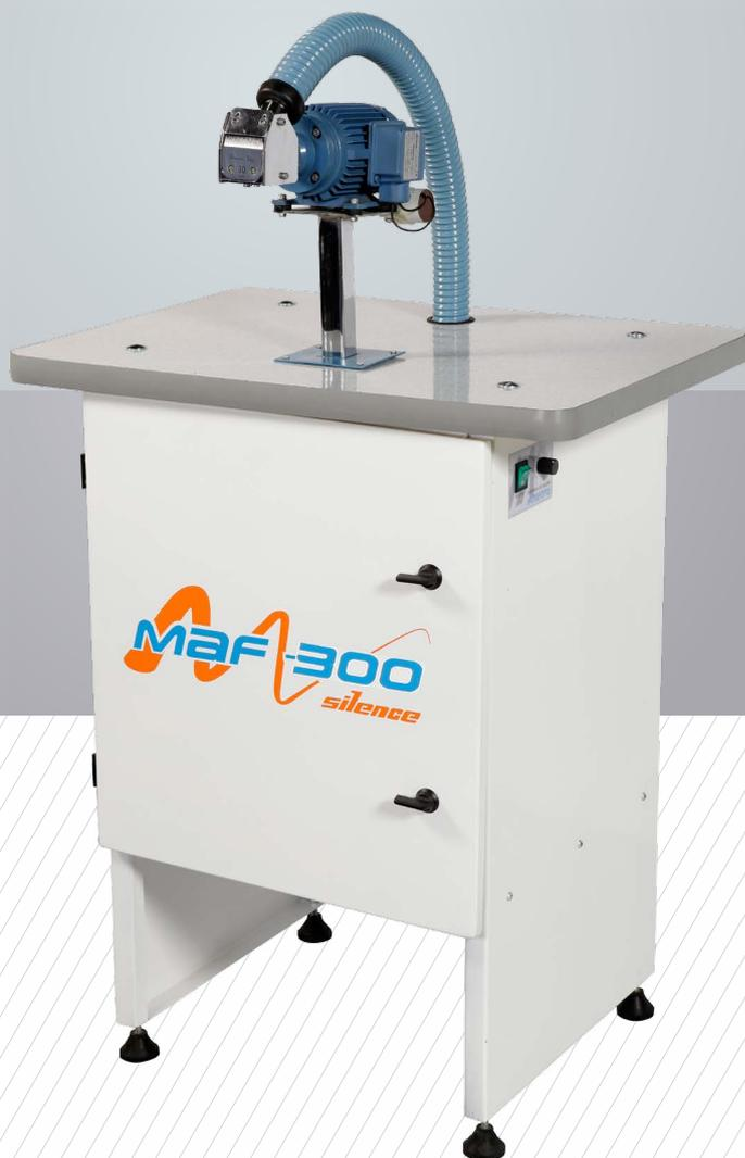
Arrematadora de Fios possui cabeçote com regulagem de altura, utilizada para limpar os excessos de fios e linhas nos mais diversos artigos. Possui sistema de sucção com motor industrial, além disso, diferencia-se por seu sistema de sucção totalmente silencioso, por possuir caixa acústica que reduz consideravelmente o ruído.
