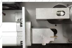
Motor de passo com velocidade ajustável e faca térmica para o corte e soldagem automática e precisa do aviamento.
